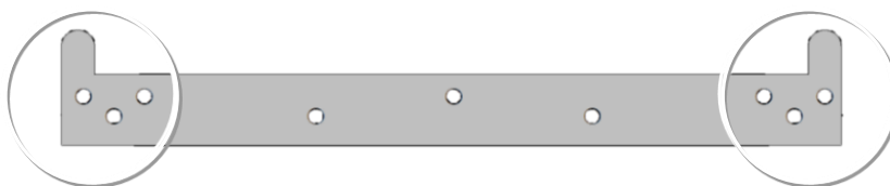
Рис. 15 Монтажная планка (кронштейн крепления котла на стене)
